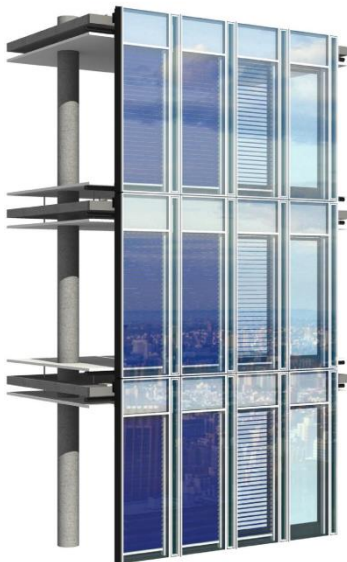
Visualisierung einer Fassade mit solarthermischer Jalousie. © Facade-Lab
