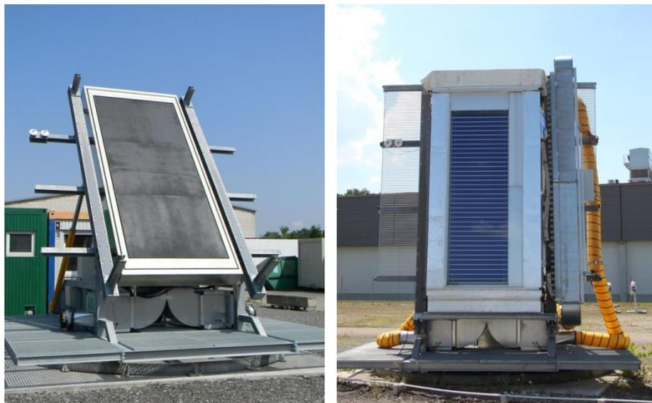
Abbildung 136: Links: OFREE-Teststand ohne Prüfling, schwarzer Absorberbereich der Messplatte sichtbar. Rechts: STJ-Labortestmuster auf dem OFREE montiert, rechts ist die Bewicklung zur Regelung des externen Wärmeübergangskoeffizienten sichtbar.
