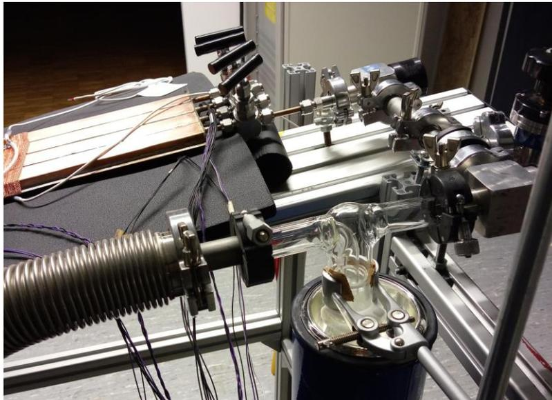
**Abbildung 46:** Prüfling der flachen Heat-Pipe nach Einlöten der Endstücke am Befüllrig des Fraunhofer ISE.
