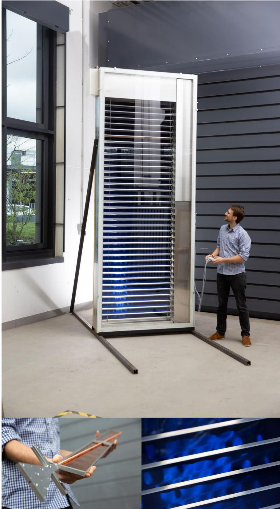
Abbildung 131: Impressionen des Labortestmusters der Solarthermischen Jalousie.
