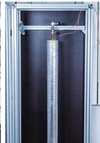
Abbildung 31: Schnelltest zur Funktionsprüfung der am Fraunhofer ISE hergestellten Heat-Pipes.
