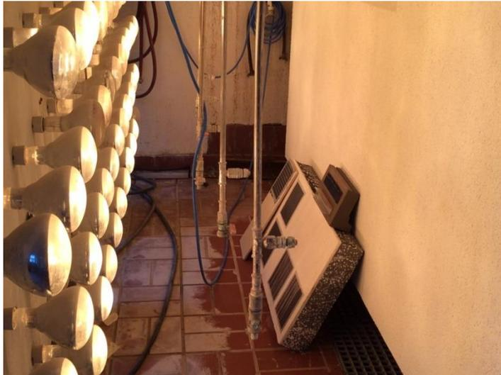
**Abbildung 70: Künstliche Bewitterung: Erhitzung der Proben durch Halogenstrahler.**
