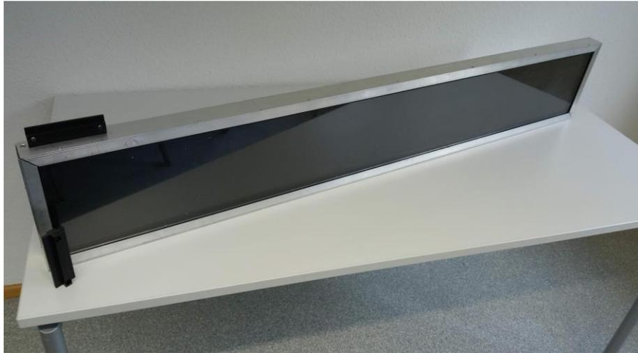
**Abbildung 88: Montagemodell des Streifenkollektors.**
