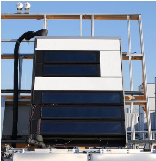
Abbildung 132: Testkollektor „Demoflex“ während der Vermessung auf dem Dach des Fraunhofer ISE.
