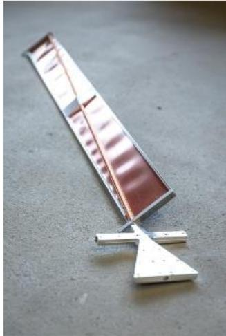
**Abbildung 91: Unterseite einer Lamelle der Solarthermischen Jalousie mit diagonal angebrachter Heat-Pipe zur Vergrößerung des Neigungswinkels der Heat-Pipe.**
