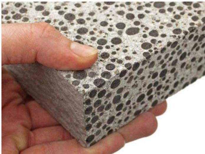
**Abbildung 13: Liapor-Leichtbetonplatte (Quelle: [www.raumprobe.de](http://www.raumprobe.de)).**
