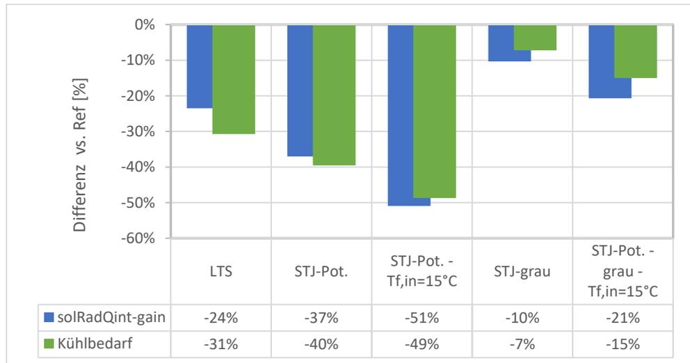
Abbildung 162: Einfluss verschiedener STJ-Varianten und Fluidtemperaturen auf die Reduktion von *solRadQint* – *gain* und des Kühlbedarf im Vergleich zum Referenzfall im Anwendungsfall Büro. ST-Betrieb mit  $T_f = 30 - 40^\circ\text{C}$  (30to40), wenn nicht anders angegeben, vgl. Tabelle 15.
